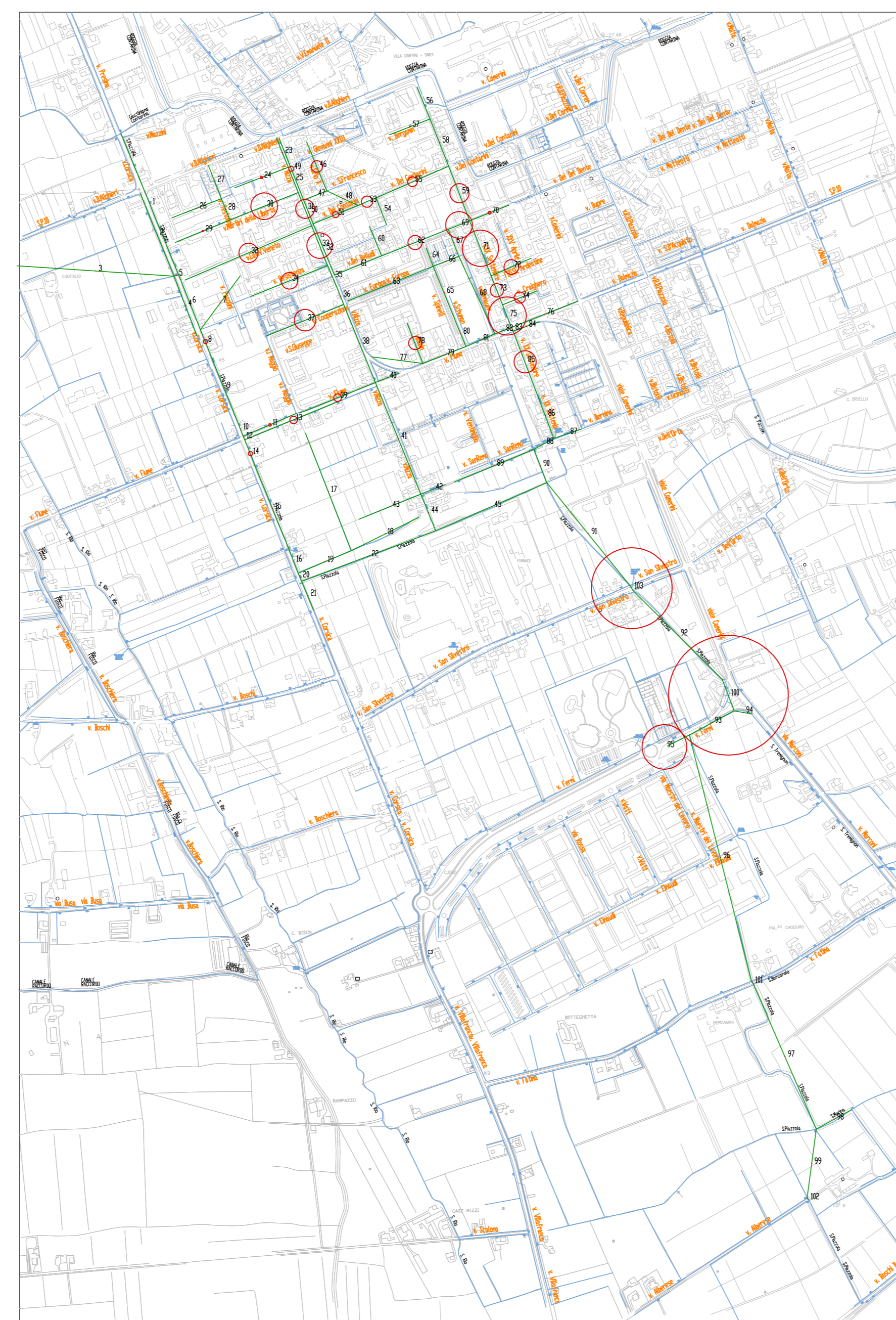
ANALISI 4 - TEMPO DI RITORNO 30 anni ZONE CON FURBESITTE' INCONTROLLATE DI ACQUA (cerchi rossi) RETE DI DRENAGGIO NELLE CONDIZIONI ATTUALI
