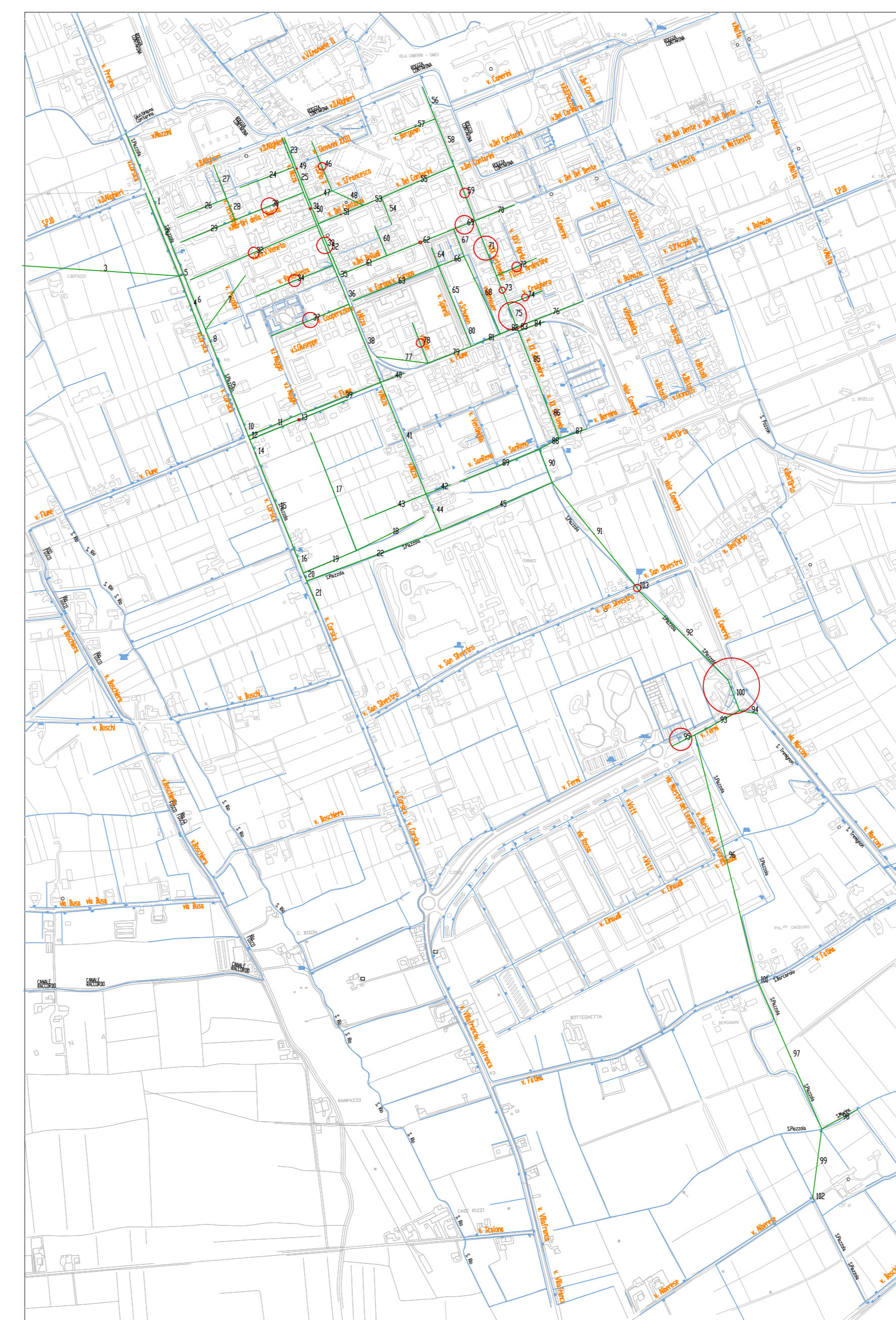
ANALISI 2 - TEMPO DI RITORNO 10 anni ZONE CON FURBESITTE' INCONTROLLATE DI ACQUA (cerchi rossi) RETE DI DRENAGGIO NELLE CONDIZIONI ATTUALI
