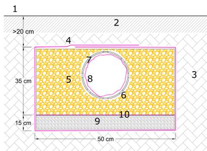
SEZIONE TRASVERSALE TIPO TRINCEA (fuori scala) CON TUBO DI DRENAGGIO IN PE CORRUGATO
